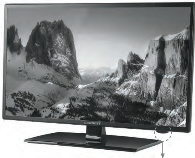
LED-aanduiding afstandsbedieningssensor (vrij houden)
