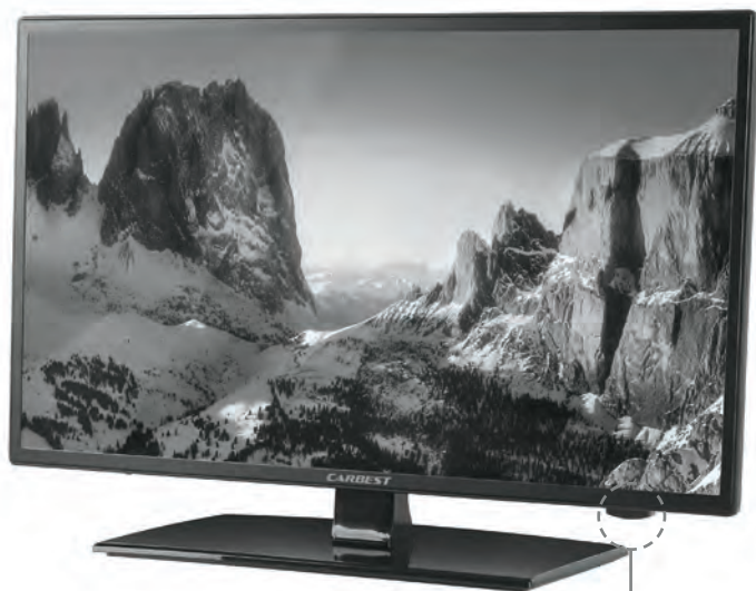
LED-indikator fjärrkontrollsensor (får inte täckas över)
